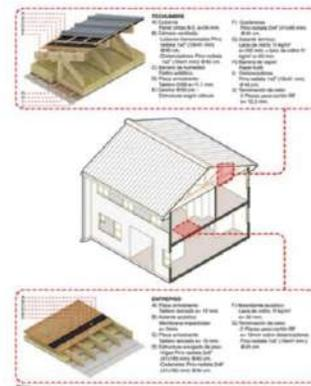
Figura 02. Soluciones constructivas de estructuras y diseño de detalles de viviendas con PDA.
