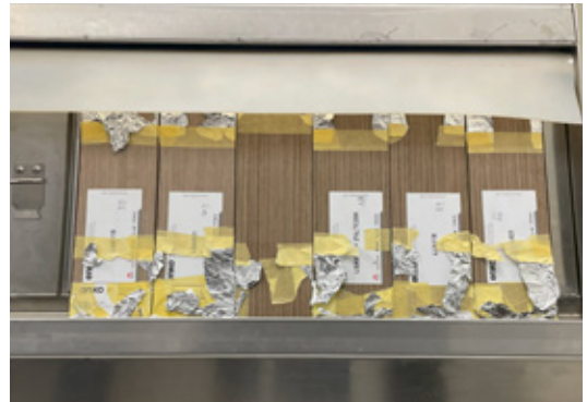
Figura 3.10 – Probetas en máquina de envejecimiento acelerado
