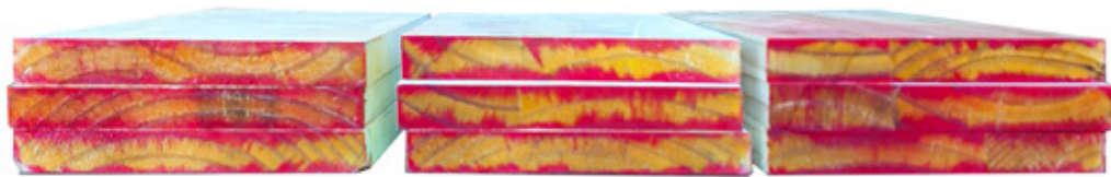
Figura 5.6 – Penetración Tratamiento Borato (Sillbor RTU) mediante el método Pulverizado manual
