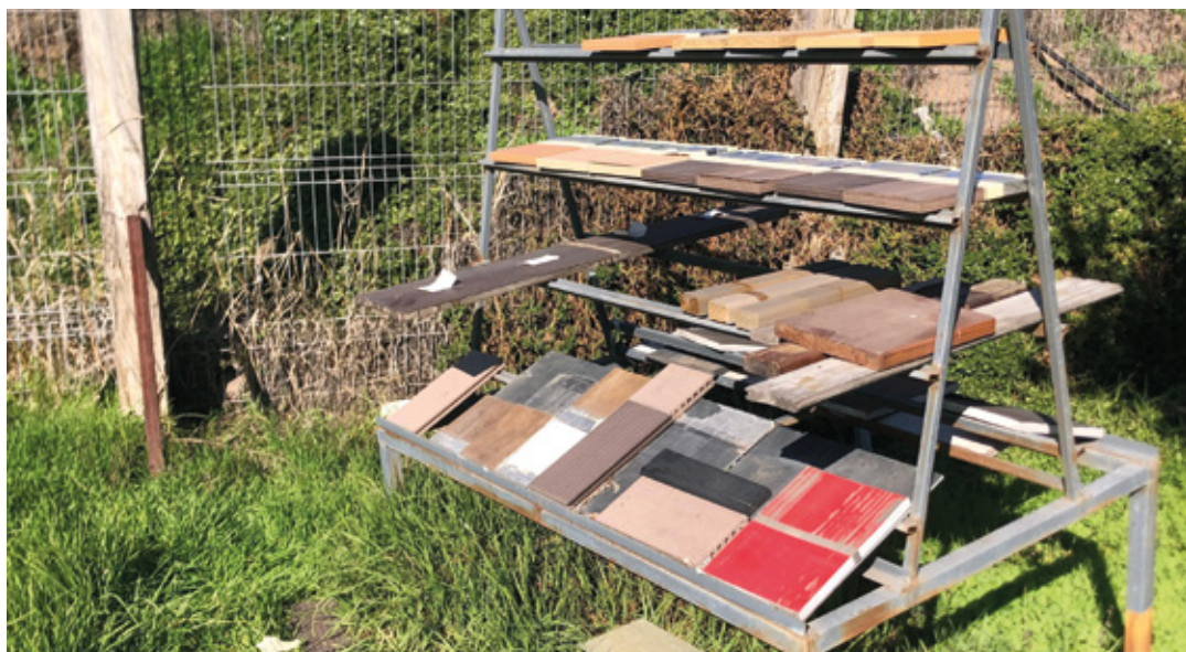
Figura 4.11 –Ensayo en terreno de productos complementarios de protección
