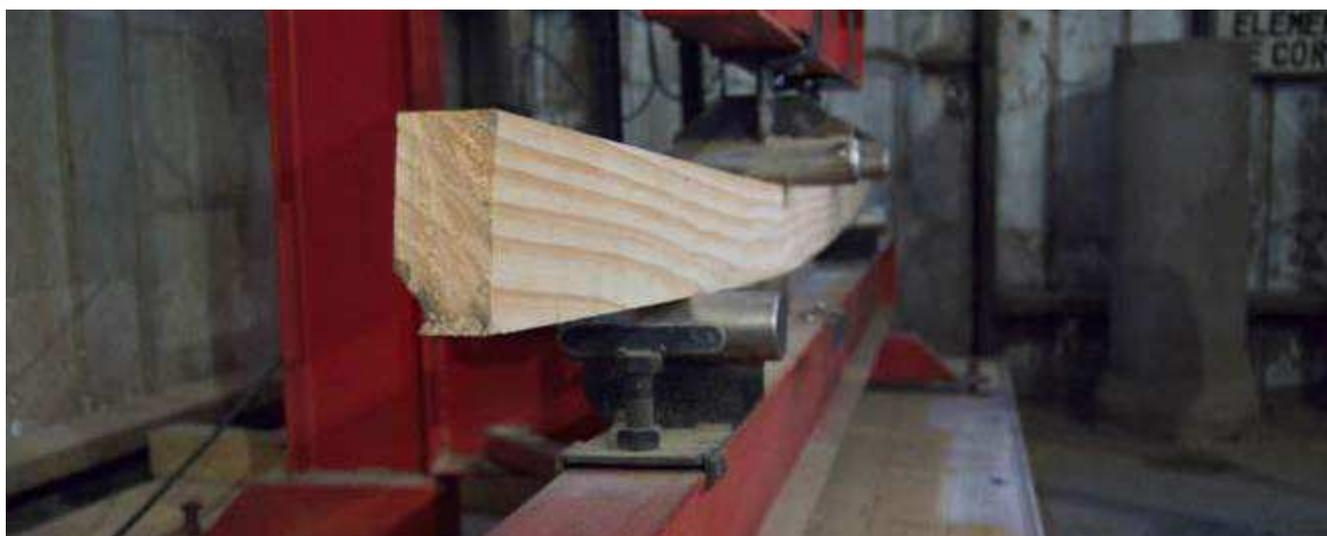
boles fueron afectados solo a nivel de corteza. Aunque se presume que esta madera lateral no será adecuada para uso estructural, el interior del tronco está en excelente estado; sin embargo, se clasifica como madera completamente quemada.
