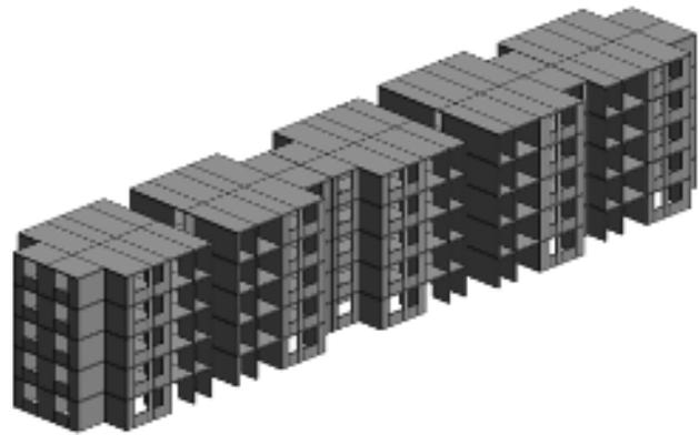
*Ilustración 8: Edificio modelado en hormigón armado*
