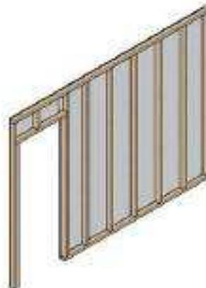
*Ilustración 11: Tabique por su cara frontal, muestra sus placas de yeso cartón.*
