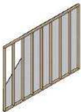
*Ilustración 12: Tabique por su cara posterior, este caso ejemplifica la posición de un vano de puerta.*
