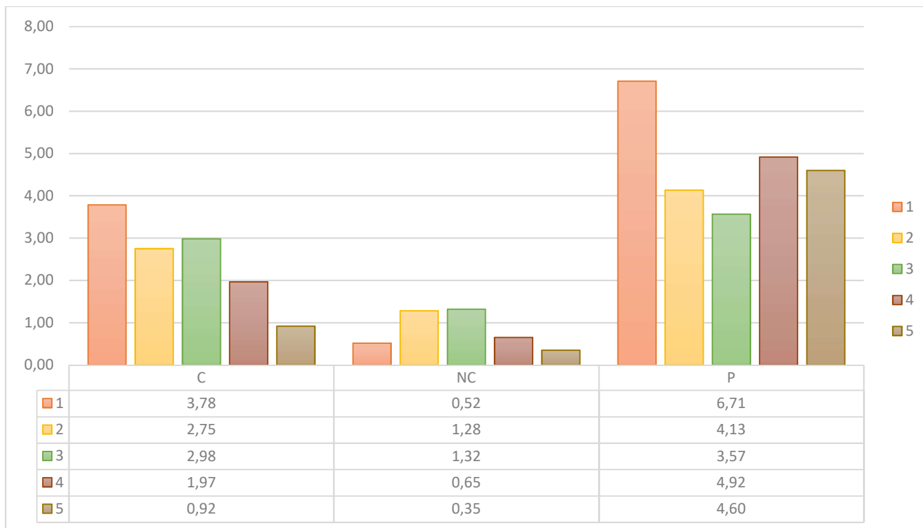
Gráfico 7-1: Distribución de Trabajos según categoría para montaje de 5 pisos de torre peñiuelas.
