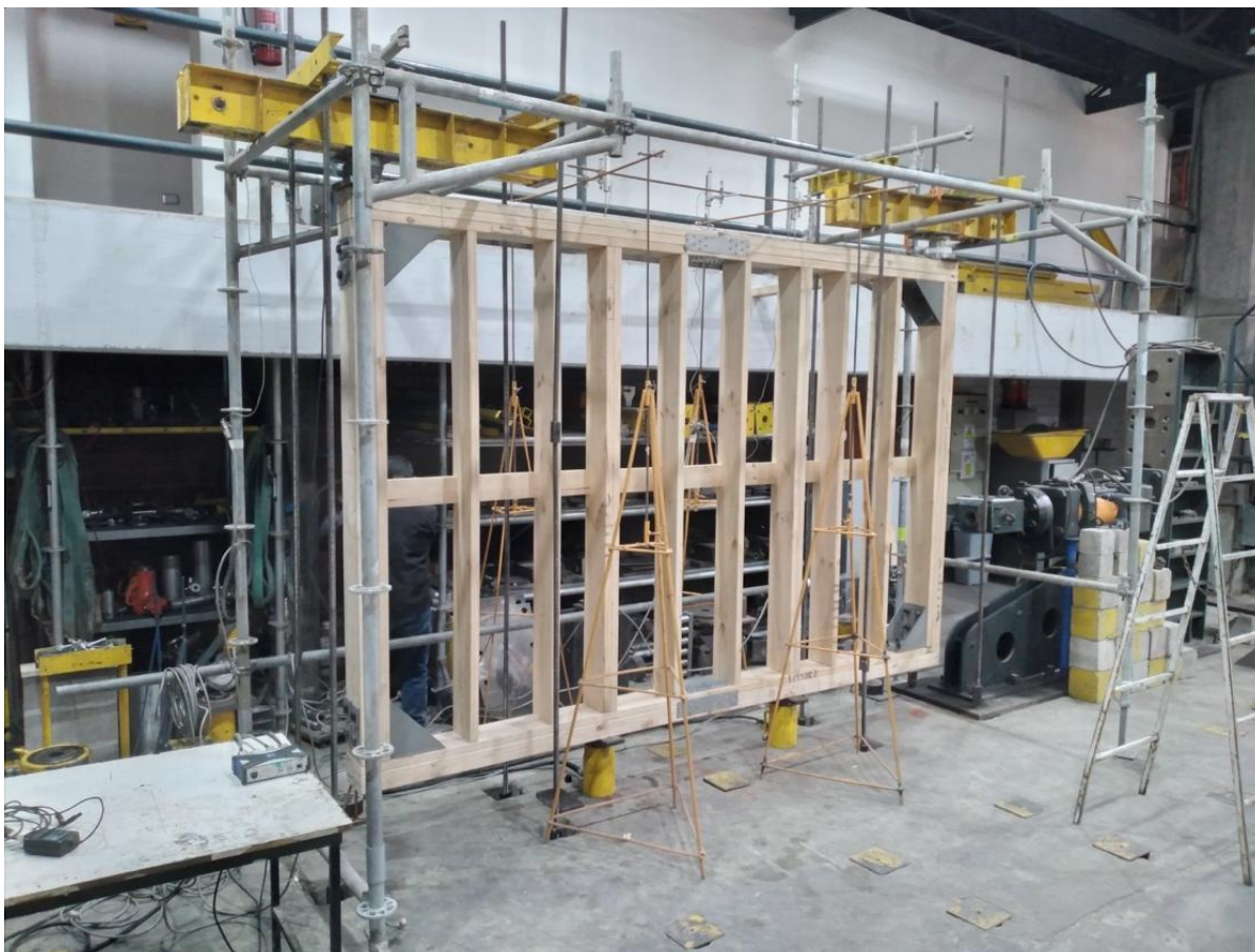
Figura 1. Marco de entramado ligero y vigas aserradas 41x185 mm.
