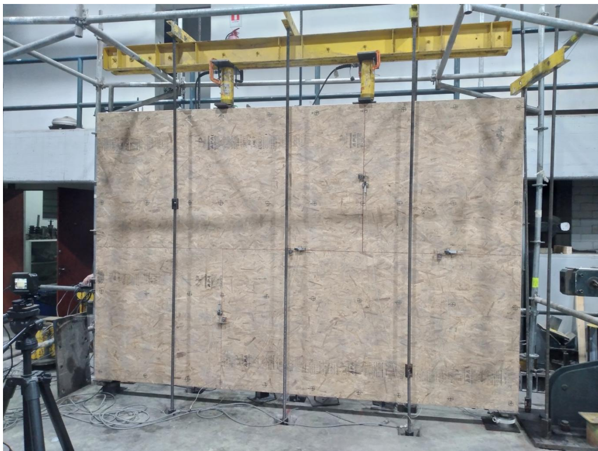
Figura 3. Configuración del ensayo de losas de entramado ligero.
