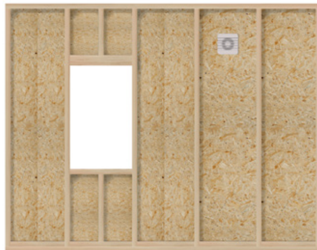
Figura 42. Inclusión de artefactos de ventilación mecánica en paneles prefabricados
