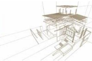
la implementación de los requerimientos establecidos en el año 2007 para toda la envolvente de la edificación. Esto entendiendo que la madera presenta una menor conductividad térmica y a que la cavidad interna dejada por el entramado estructural, permite incorporar aislación térmica a bajo costo y por sobre el estándar obtenido por otros sistemas masivos.
