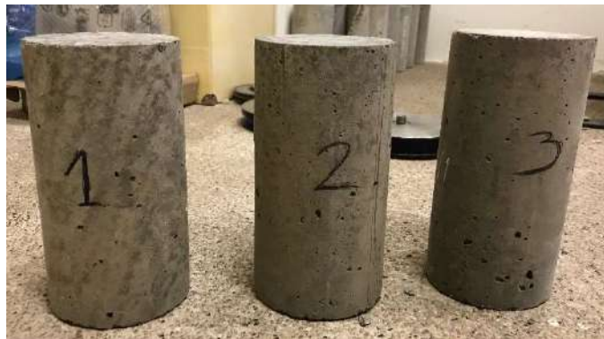
Figura 27: Registro de muestras antes del ensayo a compresión a los 28 días, parte 1.
