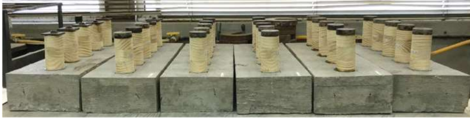
Figura 9: Probetas ensayo Pull-Off, elaboración propia.
