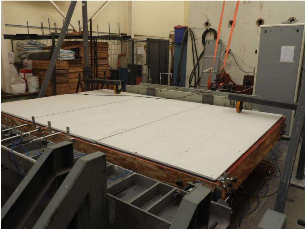
Fig 6. Diafragma con planchas de yeso cartón IJ-PLY/GWB.
