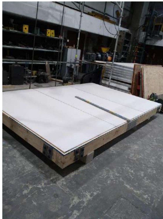
Figura 14. Instalación de planchas de yeso - cartón de 15 mm de espesor sobre probeta de entramado ligero con terciado.
