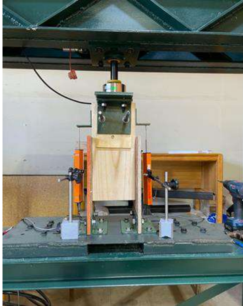
Figura 40. Conexión representativa OSB - Viga - OSB.
