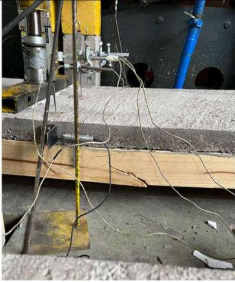
Figura 19 Fallo del NLT en probeta B-S1.
