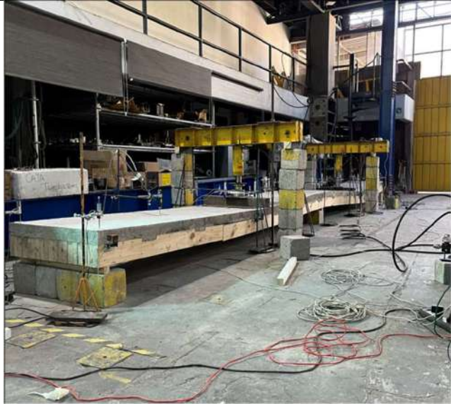
Figura 20 Probeta B-N2 después de los ensayos a flexión.
