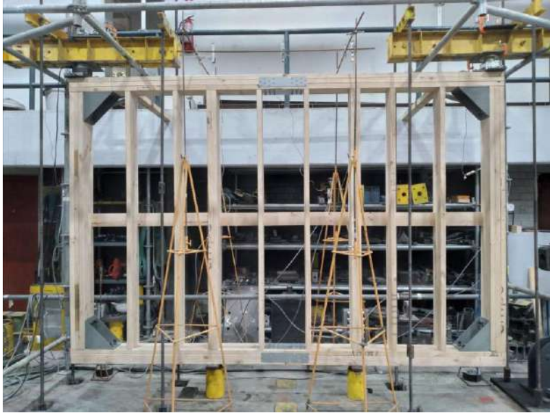
Figura 11. Vista en planta marco desnudo de probeta de entramado ligero clásico construido.
