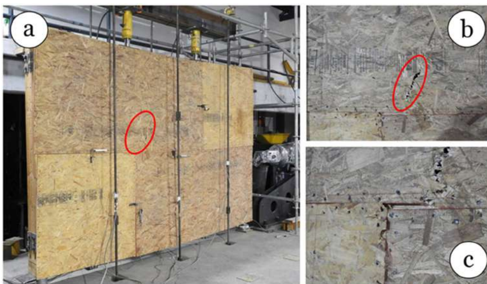
Fig 23. Modos de falla HC-OSB9.5: (a) vista del ensayo con una marca en la zona de falla por corte de tableros, (b) acercamiento a falla por corte de tablero OSB, (c) falla en los conectores.
