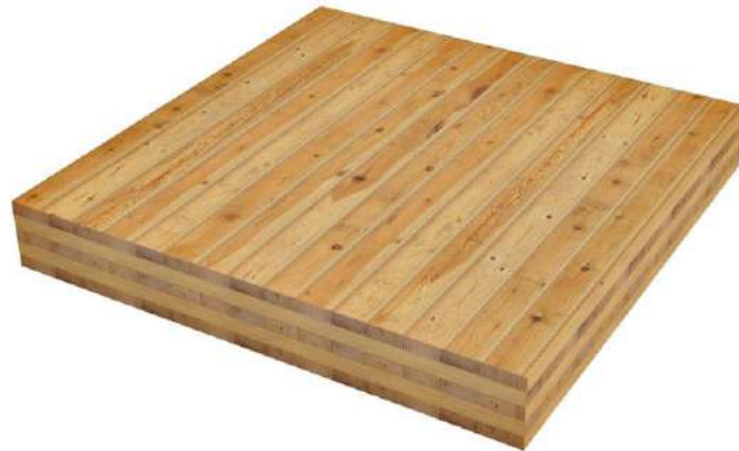
Figura 3.16. Diagrama CLT. Fuente: structurecraft.com
