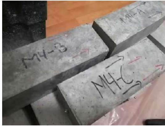
Figura 3.27. Probetas prismáticas de retracción.
