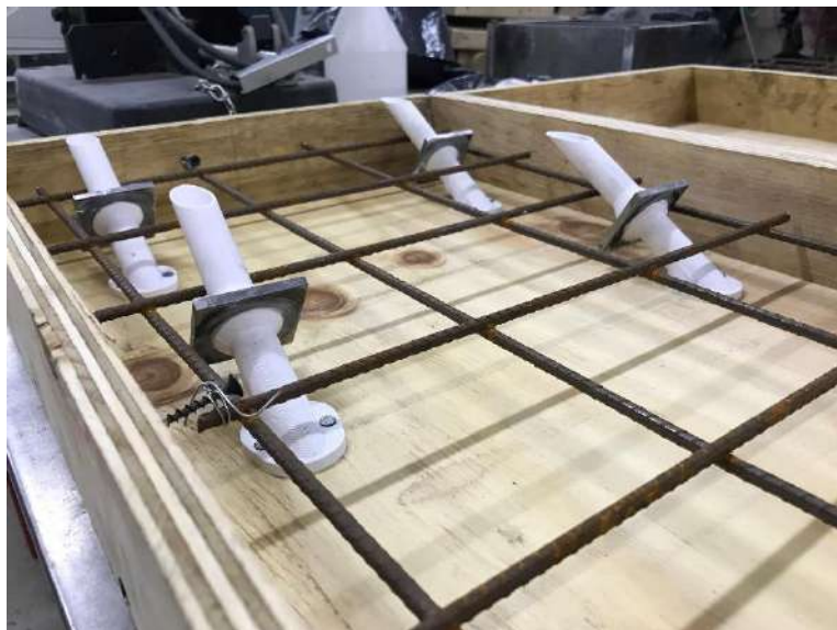
Figura 35. Soporte 3D en vista lateral y frontal.
