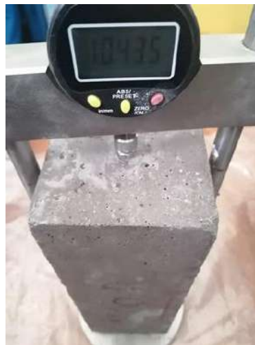
Figura 3.28. Medición de retracción de probeta prismática.
