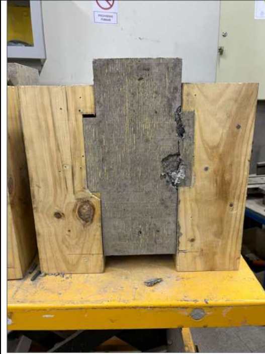
Figura 16 Modo de falla probeta N1-25.
