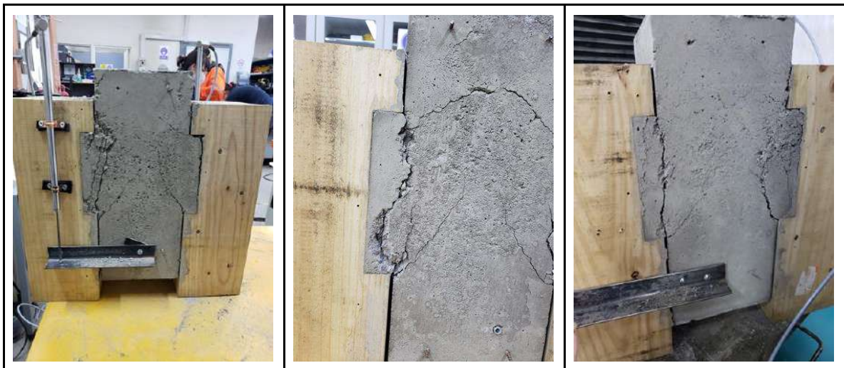
Figura 3.6. Falla probeta conexión notched.
