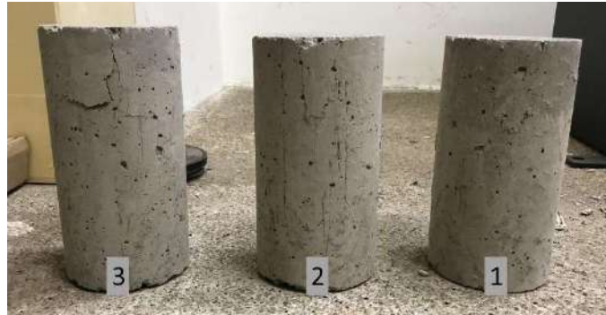
Figura 23: Registro de muestras luego del ensayo a compresión a los 14 días, parte 1.
