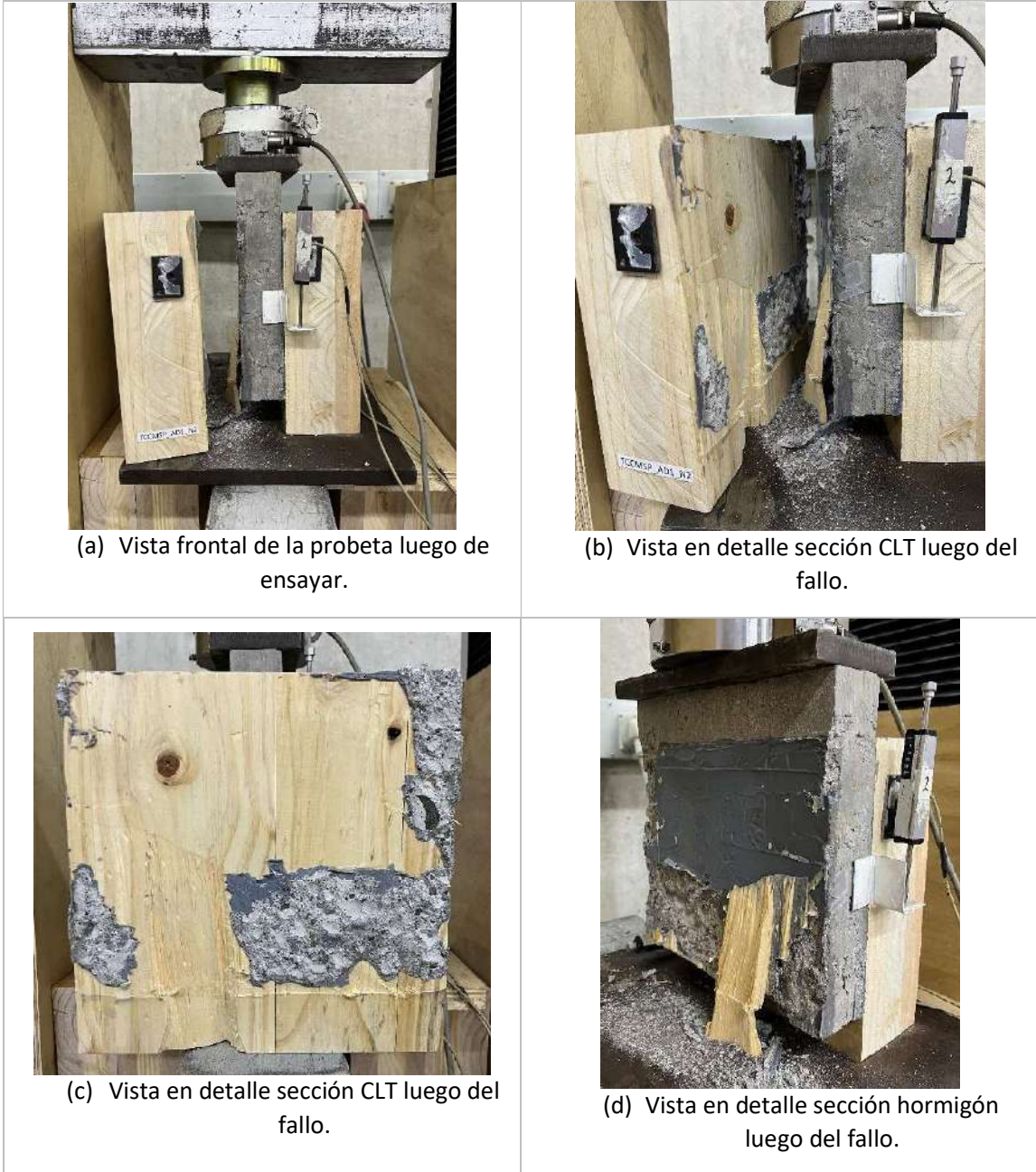
Figura 30: Resultado ensayo de corte menor de probeta prismática utilizando el adhesivo AD1, muestra 2.
