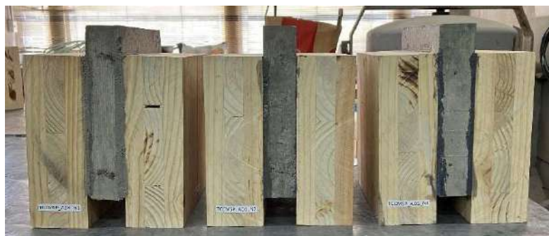
Figura 14: Probetas prismáticas ensayo de corte menor.
