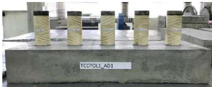
Figura 10: Vista frontal probeta de ensayo Pull-Off para adhesivo AD1.
