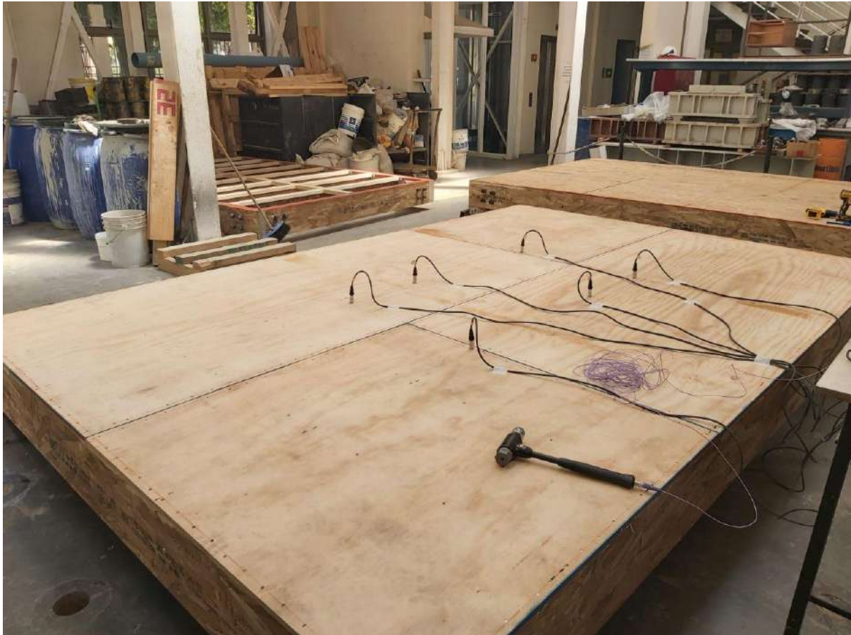
Figura 22. Vista de tres probetas en laboratorio. Al centro de imagen se presenta losa con tableros de terciado. En la zona superior derecha se presenta losa con tableros de OSB. En la zona superior izquierda se presenta losa desnuda.
