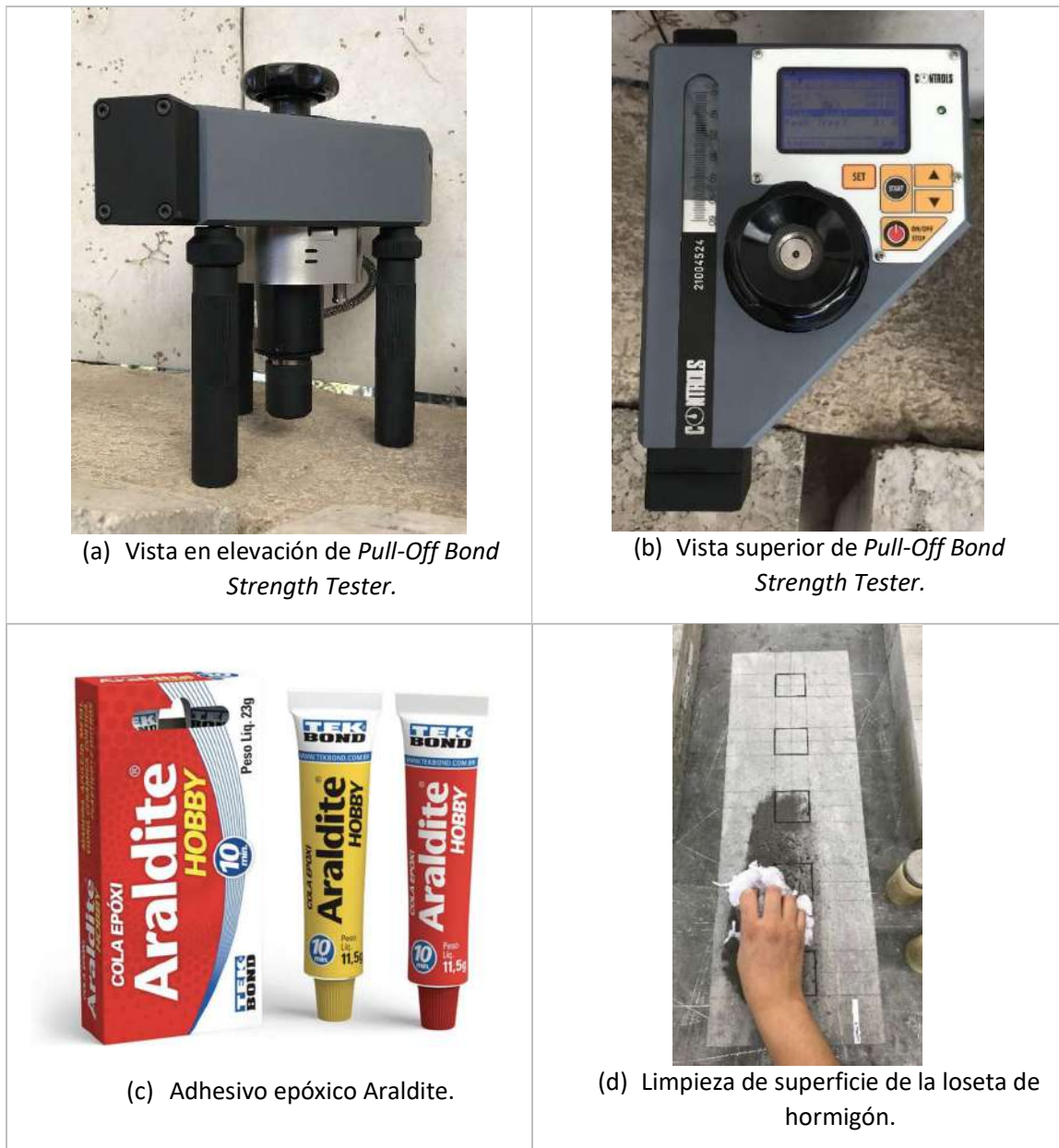
Figura 8: Componentes ensayo Pull-Off primera parte.
