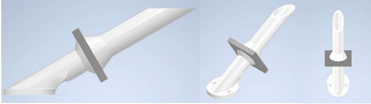
Figura 32. Vista lateral, en ángulo y superior del soporte 3D.
