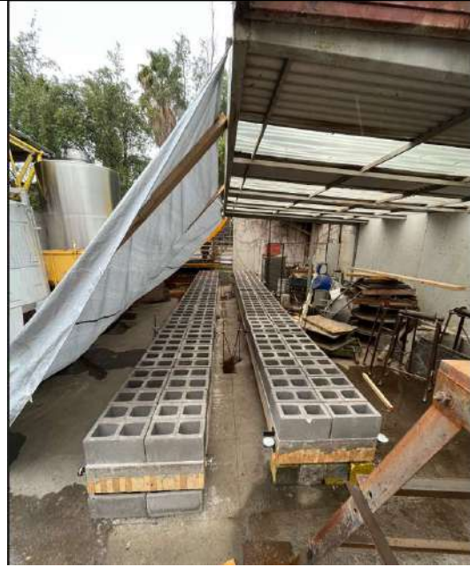
Figura 13 Probetas ensayo a largo plazo, cargadas con bloques de hormigón.
