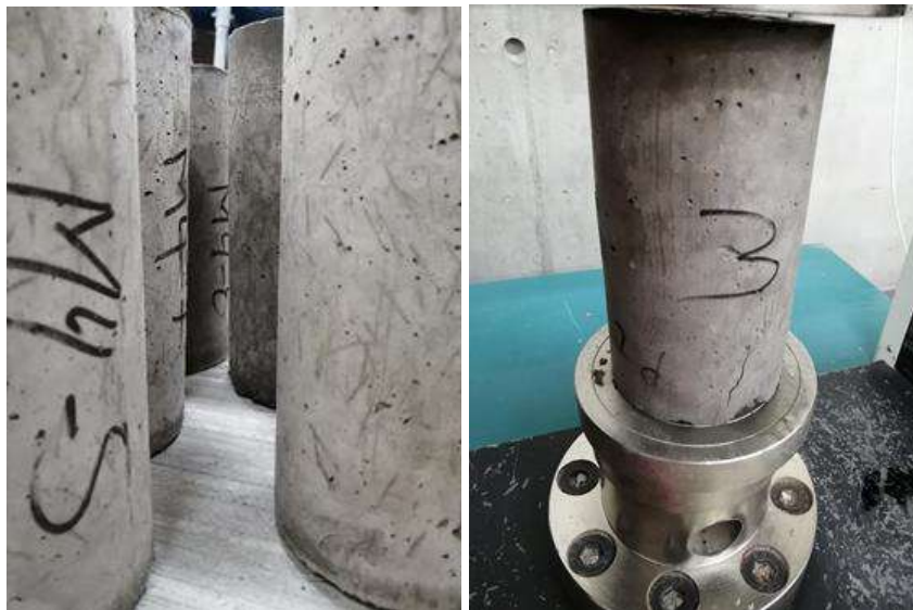
Figura 3.26. Probetas de compresión con fibras.
