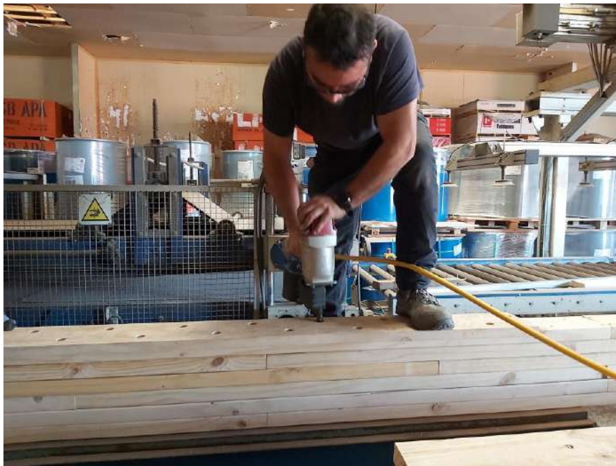
Figura 4. Proceso de fabricación probeta NLT en industrializadora.
