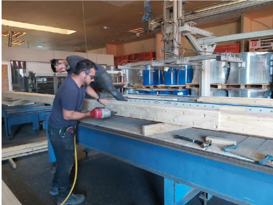
Figura 3. Proceso de fabricación probeta NLT en industrializadora.
