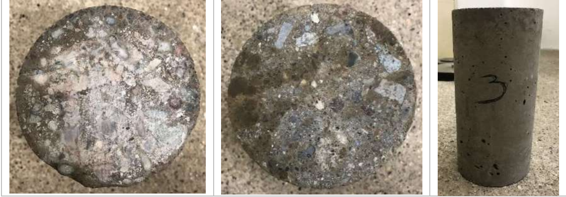
Figura 26: Muestra 3 ensayo a compresión a los 28 días, parte 1.
