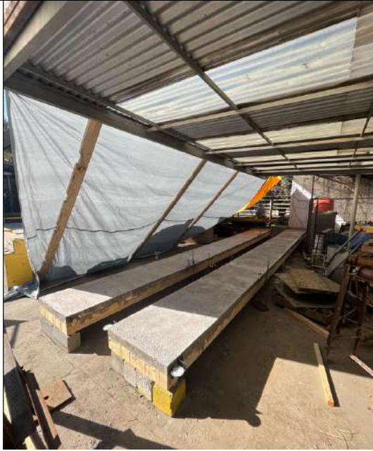
Figura 12 Probetas ensayo largo plazo, previo a la carga.
